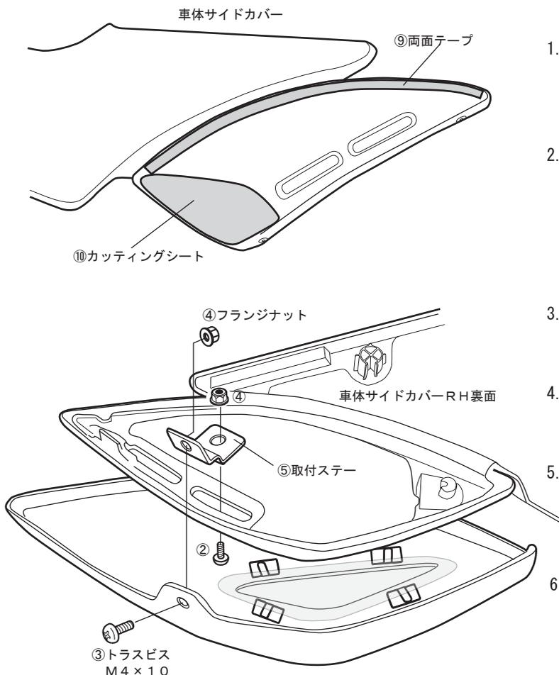
1. 図を参照して、車体から外したサイドカバーを脱脂して⑨両面テープを貼って、ダクトの位置に⑩カッティングシートをカットして貼ってください。
