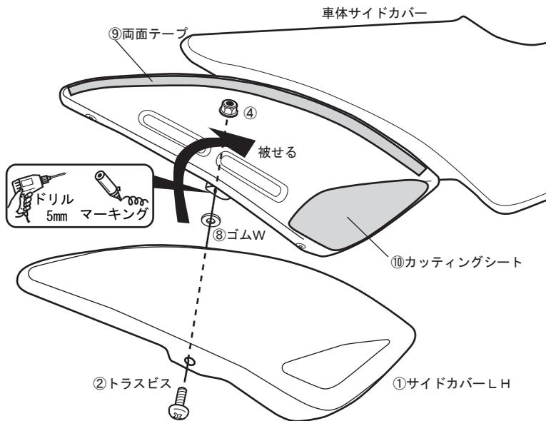
1. 図を参照して、車体から外したサイドカバーを脱脂して⑨両面テープを貼って、ダクトの位置に⑩カッティングシートをカットして貼ってください。
