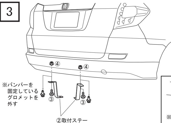
1. 図を参考にして、車両からバンパーを固定しているグロメットを外してください。(2ヶ所)
